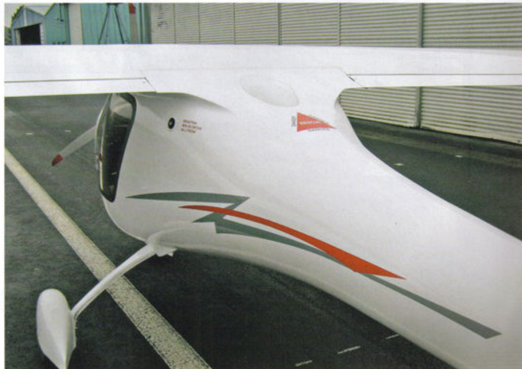
Wichtige Öffnungen: Der Tankstutzen sitzt gut zugänglich links hinter der Tür. Das Rettungssystem schießt hinterm Flügel nach oben aus
